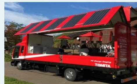
1.2kwの太陽光パネル設置 ウィング可動により集光率アップ
