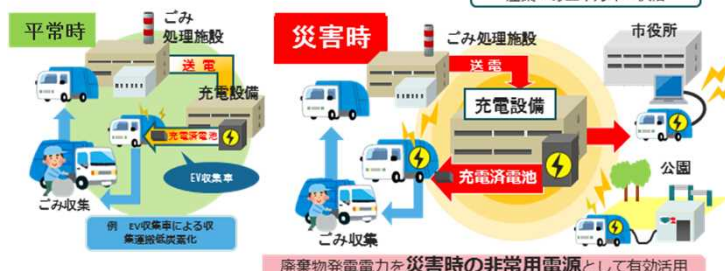
廃棄物発電電力を災害時の非常用電源として有効活用
