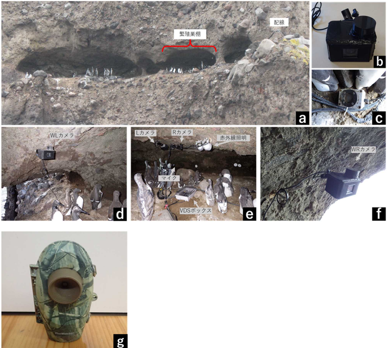
図 2. (a) 赤岩対岸のウミガラスの繁殖巣棚, (b) 繁殖巣棚内に設置したフィルム巻き取り式防汚装置付き CCD カメラ, (c) 繁殖巣棚内に設置した小型スピーカー, (d) 入口側からみて繁殖巣棚の左部分 (WL カメラは広範囲を撮影できるように設置), (e) 繁殖巣棚の中央部分 (左から L カメラ, R カメラ, マイクはデコイの嘴部分に装着, 繁殖巣棚の天井に赤外線照明を設置), (f) 繁殖巣棚の右部分 (WR カメラは広範囲を撮影できるように設置, ), (g) 繁殖巣棚内に設置したインターバルカメラ.
