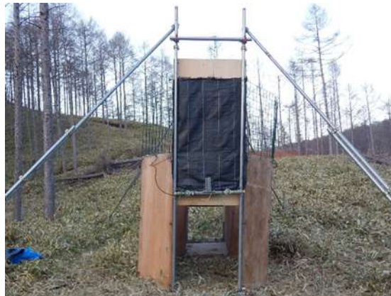
図 2-3 体重計測式小型囲いワナ
