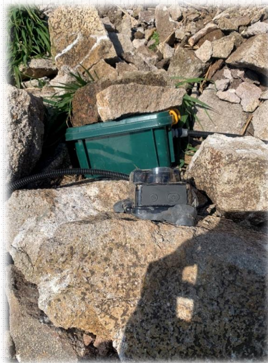
電源を入れたコンテナと インターバルカメラ
