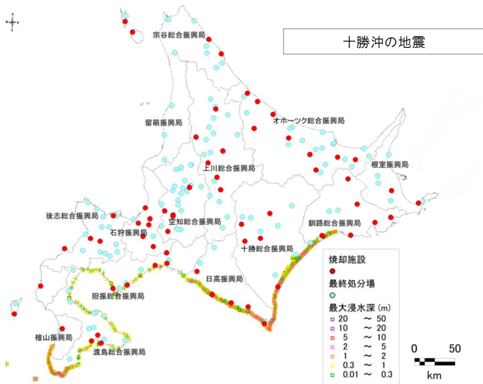
図● 一般廃棄物処理施設の所在地と津波浸水範囲
