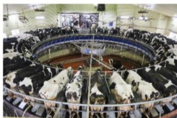
搾乳設備 (ロータリーパーラー)
