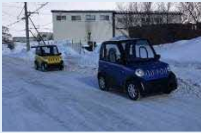
積雪寒冷地に適した超小型EVの改造、走行実証試験 (一社)集落自立化支援センター (西興部村)
