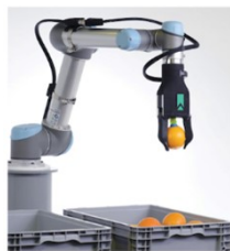
ピッキングロボット
