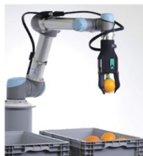
ピッキングロボット
