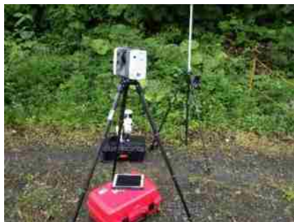
地上型レーザスキャナを活用し、 3次元設計データを作成
