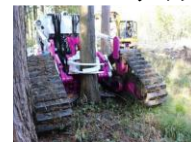
遠隔操作の伐倒機械
