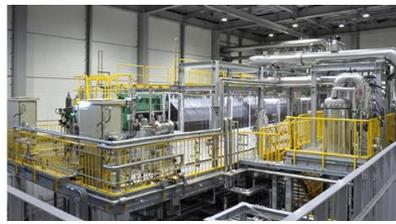
10MWの水電解装置
