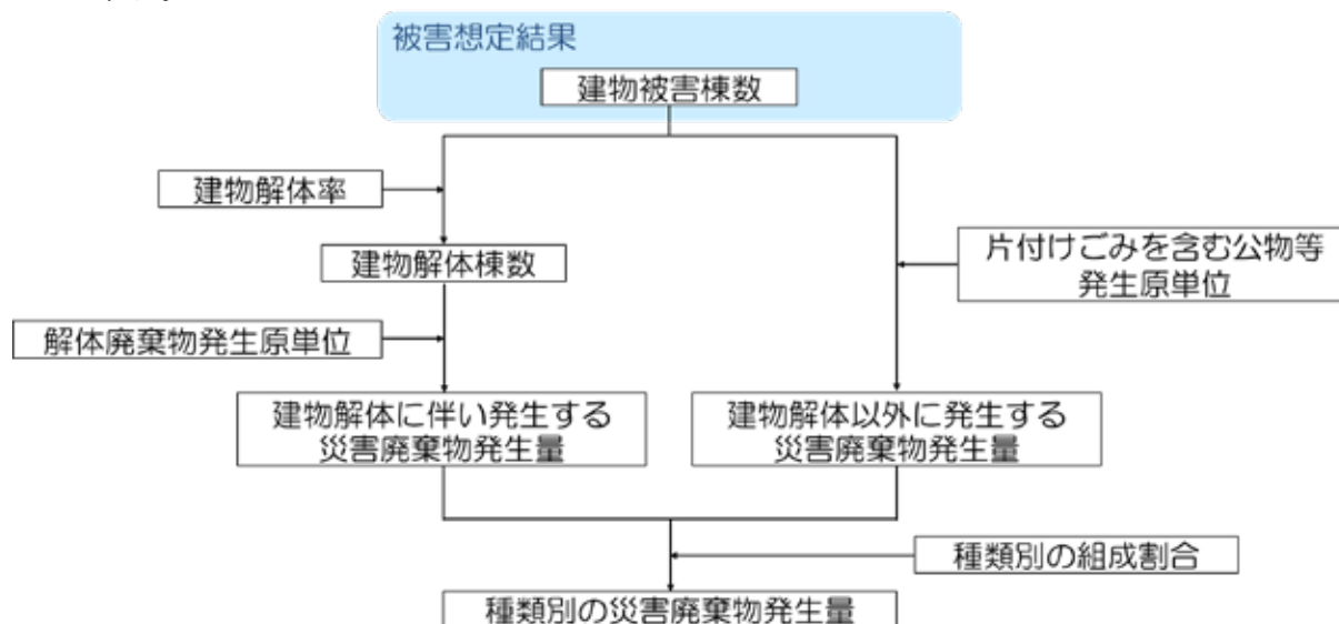
図 2-6-2 災害廃棄物発生量推計の流れ
