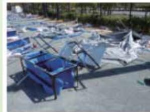
風で転倒したテント型の組立トイレ
