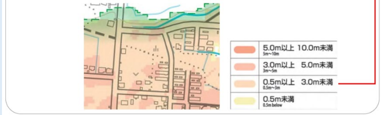
図 3-5 浸水深と建物被害区分の設定例
