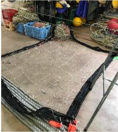
写真 1. 水産ファスナーを取り付けた防除網
