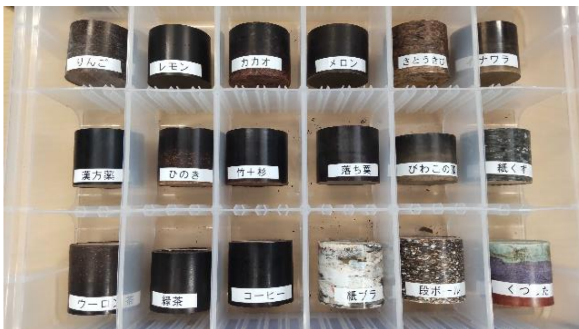
図1 各種原料による高密度・高硬度な固体バイオ燃料；バイオコークス
