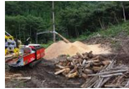
移動式チッパーによる 木質バイオマス燃料の生産
