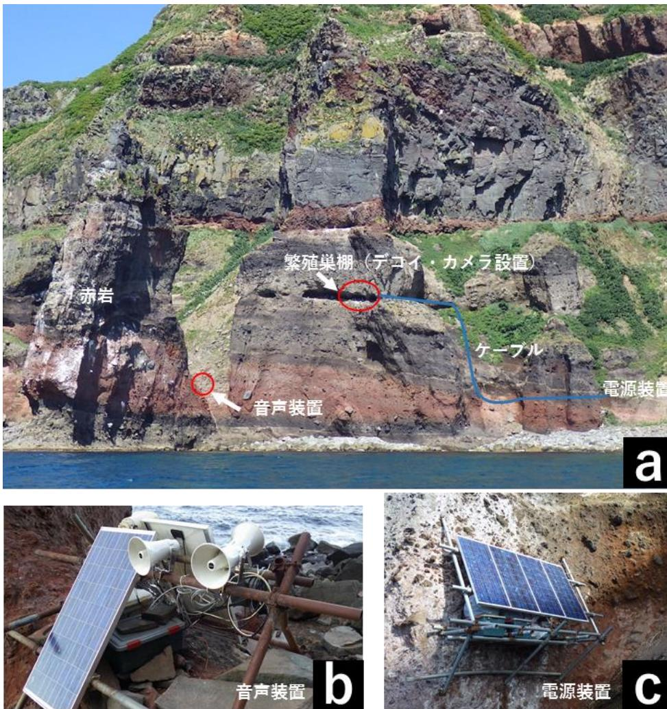
**図 2.** (a) 切り立った崖のなかほどにある赤岩の対岸に位置するウミガラスの繁殖巣棚（赤岩対崖）と全体の概要。 (b) 音声装置の概要。音声装置は、2枚の太陽電池パネルで1つのバッテリーを充電して、4つのスピーカーからウミガラス声を日中のみ再生した。 (c) 電源装置の概要。電源装置は4枚の太陽電池パネルで4つのバッテリーを充電した。約60mのケーブルで繁殖地に設置したCCDカメラに電力供給し、太陽電池パネルの下に設置した録画装置に映像を記録。
