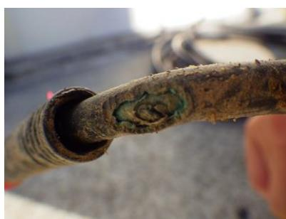
図4. ケーブルの損傷状況
