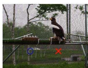
▲感電対策-止まりを防止するための器具の実験
