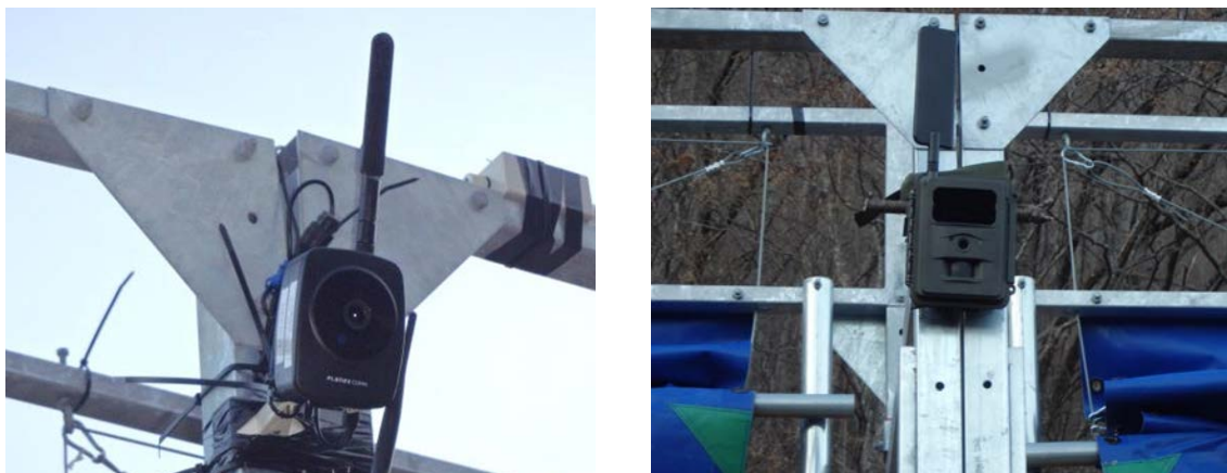
写真 1-5 監視部の設置例 (左: スマカメ 2 LTE、右: ハイクカム LT4G)
