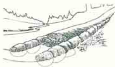
石を置いたターンパイプ (Grock tunnel)
