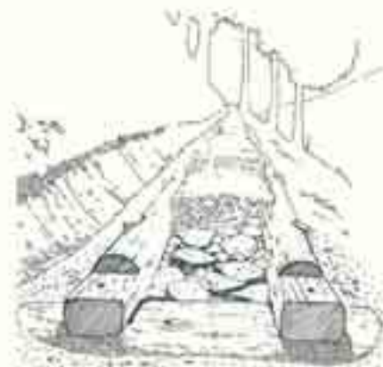
丸太を置いたターンパイプ (log tunnel)。まず、斜の字線にあるように、内側に竹筒を敷き (cane box と呼ぶ)、その上に横置の丸太を敷く。
