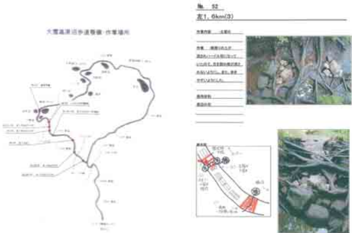
図 14 カルテ参考例：「ヒグマ情報センター」による大雪高原沿歩道整備の記録（佐藤委員提供） 位置、作業内容（概念図）、修復の理由、目標（ねらい）、使用材料、作業前後写真等を記録
