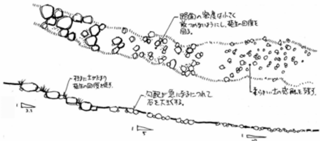
図 31 路面処理模式図
